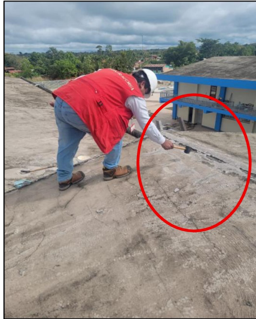
Imagen n.º 14 Prueba de percusión con martillo de goma
