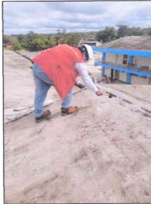
Imagen n.º 2 Prueba de percusión con martillo de goma
