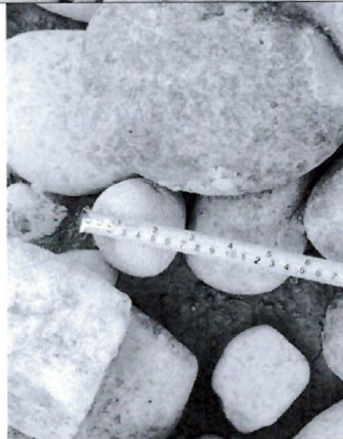
La medida de algunas piedras que conforman el conjunto de bolonera (Over), tiene una medida de 3" aproximadamente.
