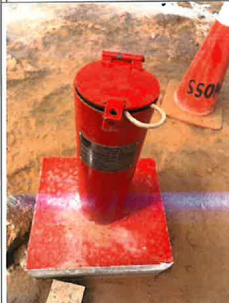
Fotografía N° 9: Vista de piezómetro S-8 en el exterior del Bloque A, Dique Norte del Terminal de Pasajeros, visto desde el piso 1.
