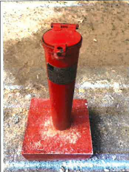
Fotografía N° 7: Vista de piezómetro S-2 en el exterior del Bloque A, Dique Norte del Terminal de Pasajeros, visto desde el piso 1.
