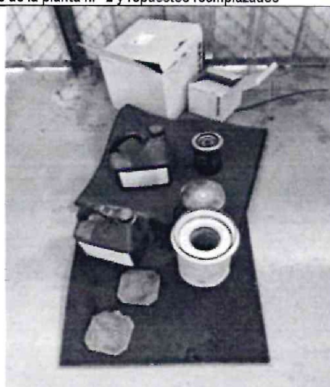
Filtros de aire y aceite cambiados del compresor de aire
