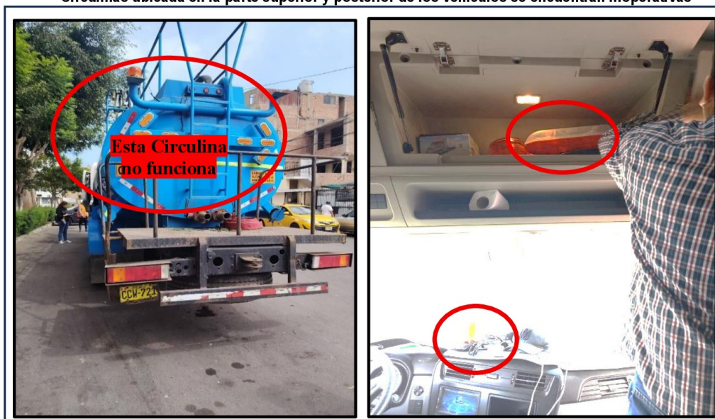
Imágenes n.ºs 03 y 04 Circulinas ubicada en la parte superior y posterior de los vehículos se encuentran inoperativas
