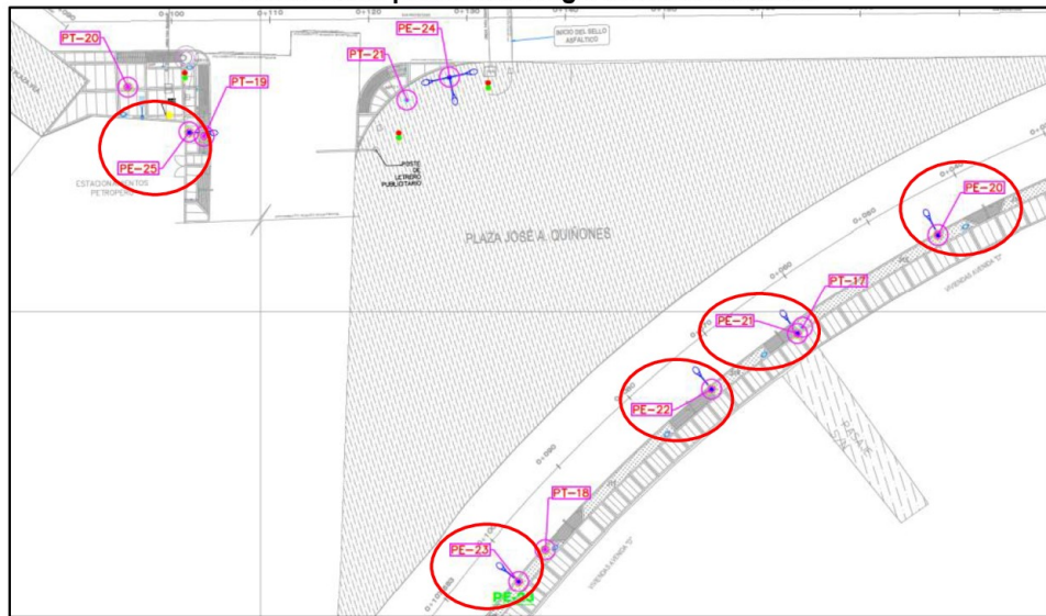
Figura n.º 7 Ubicación de postes de energía eléctrica a reubicar
