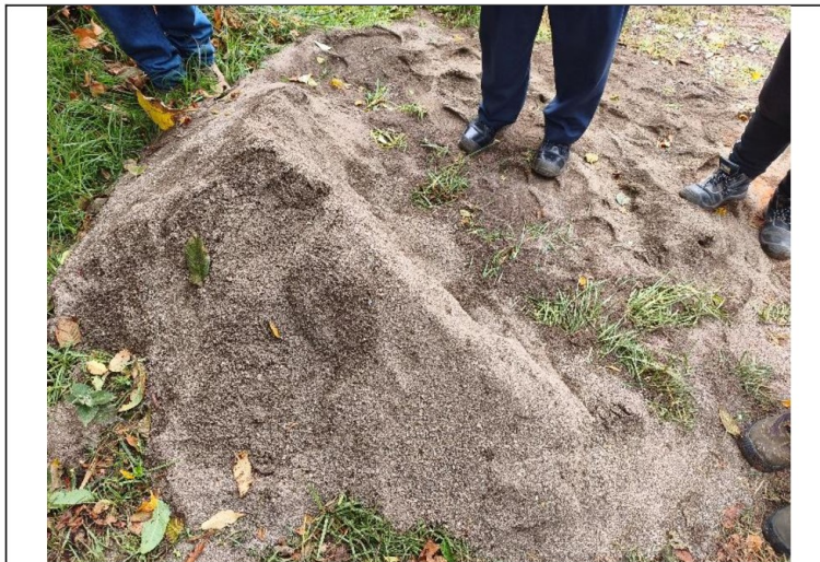
Presencia de materia orgánica en arena gruesa.
