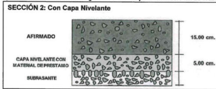
Imagen n.° 18 Capa de material de afirmado según el informe de pavimento del Plan de Trabajo
