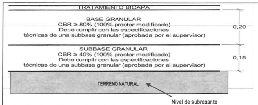
IMAGEN N° 10 SECCIÓN TÍPICA DEL PAVIMENTO FLEXIBLE
