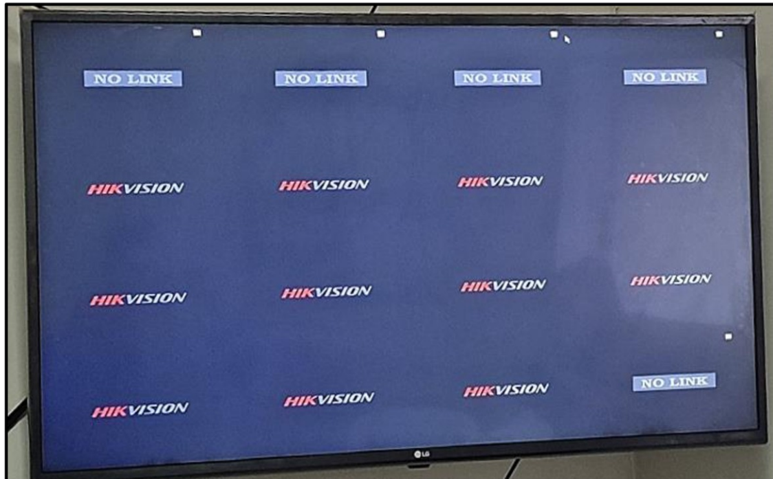
Imagen n.º 4 Cámaras de videovigilancia que no transmiten información por falta de mantenimiento
