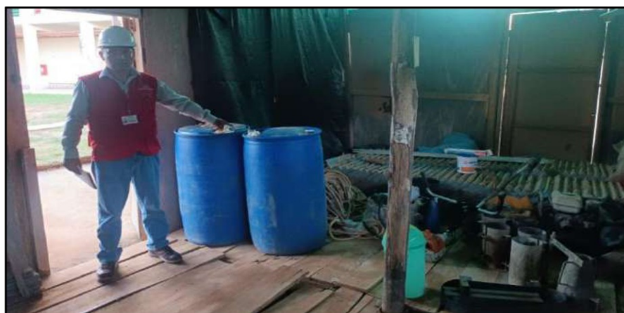
Imagen n.º 15 Combustible almacenado cerca a la puerta de salida de Almacén
