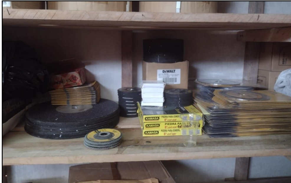
Imagen n.º 10 Discos de corte sin su respectiva tarjeta de control visible
