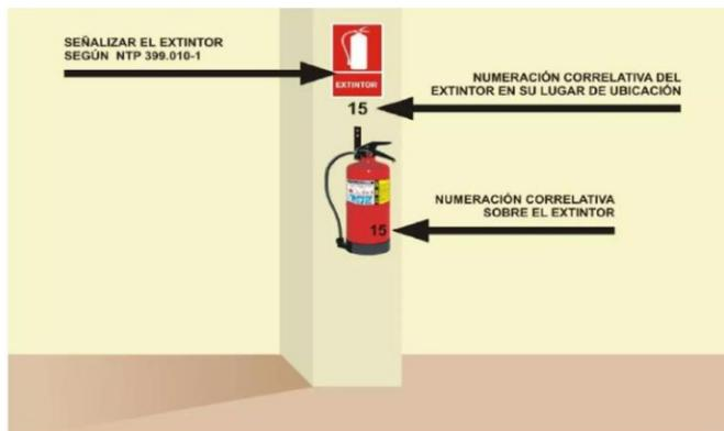
FIGURA 3 – Señalización del extintor
