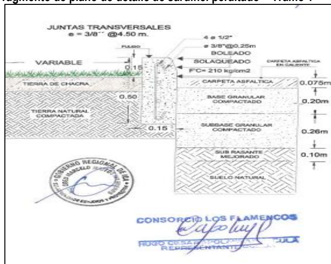
Imagen n.º 20 Fragmento de plano de detalle de sardinel peraltado – Tramo 1
