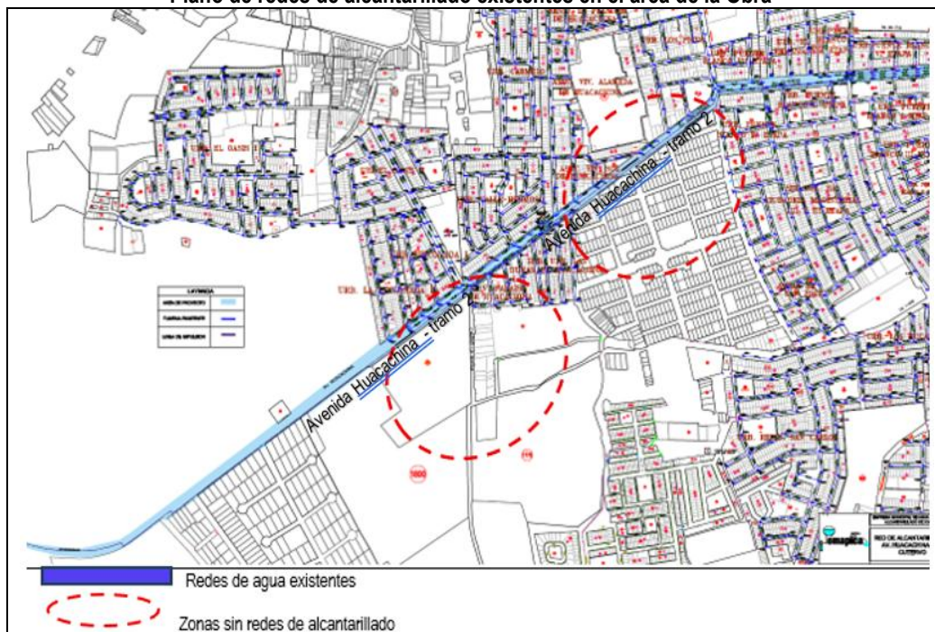
Imagen n.° 16 Plano de redes de alcantarillado existentes en el área de la Obra
