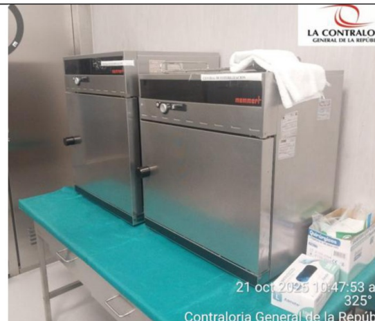
Imagen 11: Equipo esterilizador eléctrico de calor seco, proveniente del Hospital Existente.
