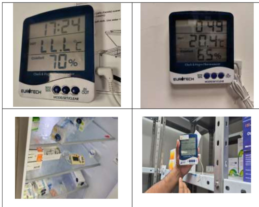
Imágenes n.º 25, 26, 27 y 28 Termohigrómetros digitales inoperativos o carentes de certificados de calibración
