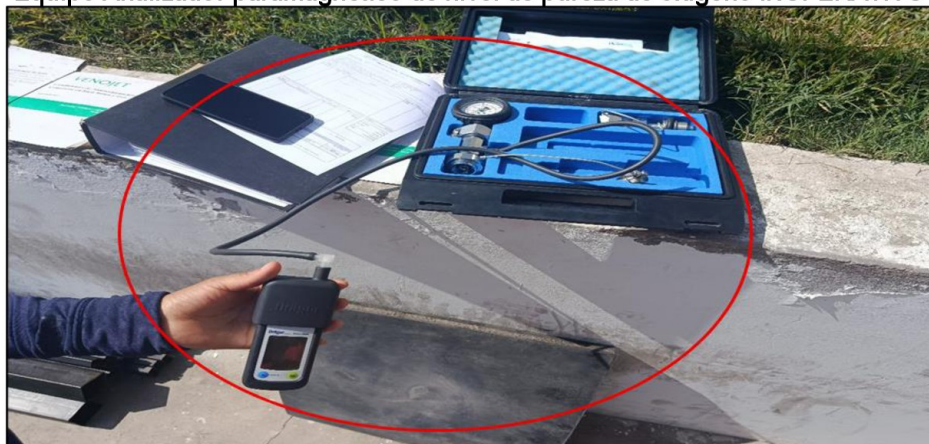
Imagen n.º 4 Equipo Analizador paramagnético de nivel de pureza de oxígeno INOPERATIVO
