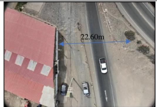
**Imagen n.º 18:** vista de la sección de la carretera a 22.60m, siendo la sección propuesta de 27.60m
