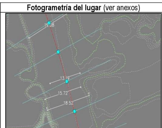
**Imagen n.º 26:** Curvas de nivel obtenidas con fotogrametría entre la progresiva Km 6+340 al km 6+420, para identificar posibles interferencias de estructuras adyacentes.
