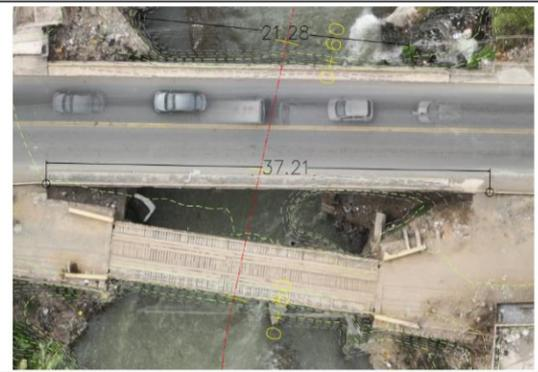
**Imagen n.º 36:** Puente vehicular ubicado en el río Huaura, presenta una longitud de 37.21, sin embargo, la longitud propuesta de diseño es de 33.53, siendo esta incompatible con el terreno.
