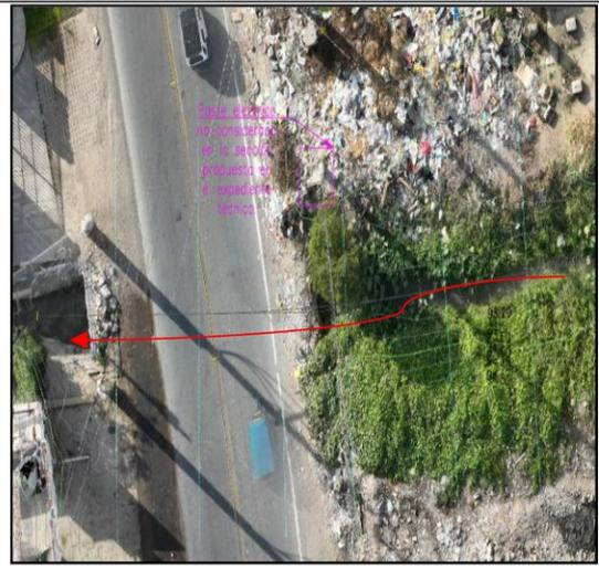
**Imagen n.º 28:** De la fotogrametría del terreno se identificó la presencia de un canal el cual atraviesa el ancho de vía, reduciendo así el terreno para la ejecución de la sección propuesta en el Exp.Tec.
