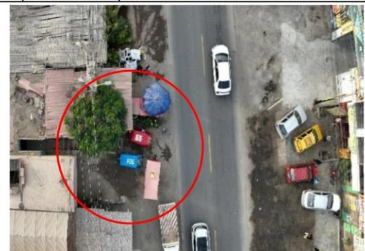
**Imagen n.º 24:** De la fotogrametría del terreno se aprecia viviendas que invaden el ancho de vía, que a su vez se encuentra a 4.22 m del borde de la carretera, siendo la sección propuesta incompatible con el terreno.
