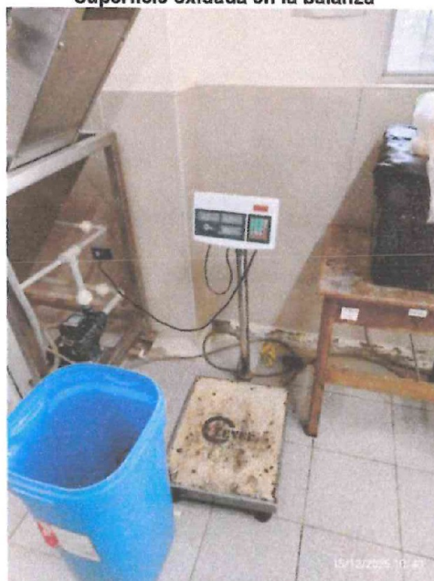
Imagen n.º 27 Superficie oxidada en la balanza
