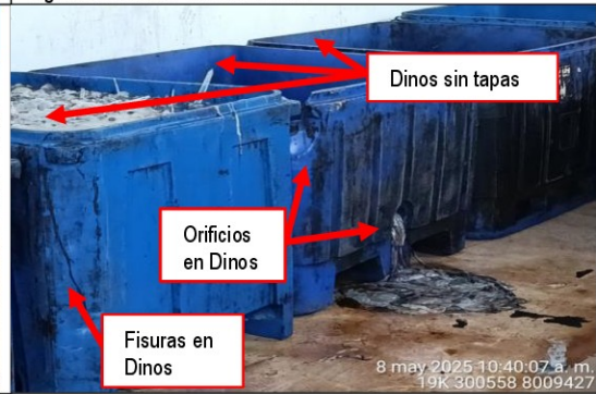
Fotografía n.º 6: Dinos del Almacén Temporal de Residuos Sólidos, con rajaduras, orificios y sin tapas.
