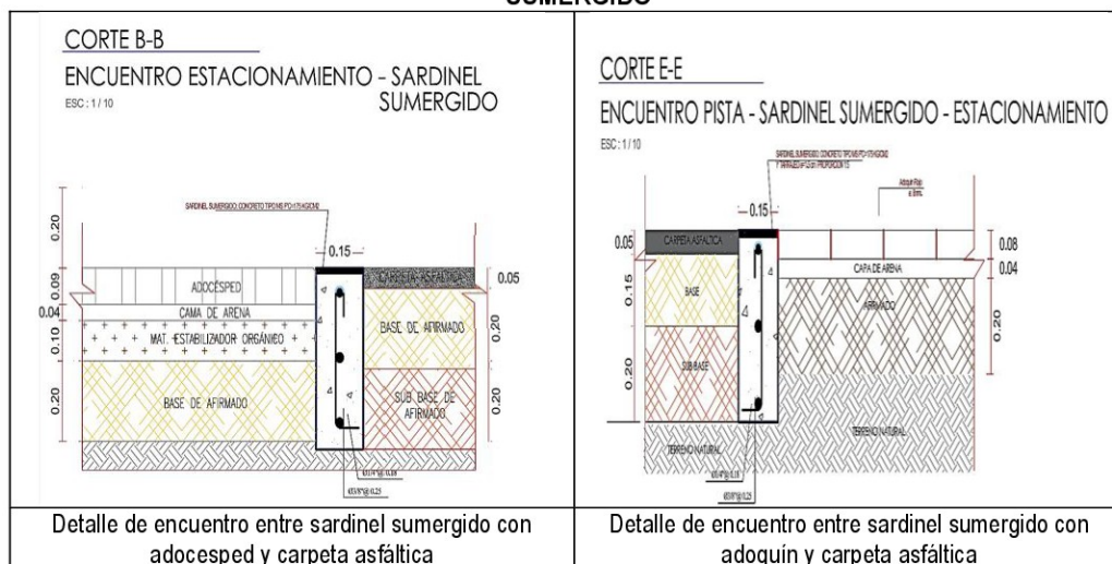
IMAGEN N°s 10 Y 11 UNIÓN DE ADOCÉSPED Y ADOQUIN CON CARPETA ASFÁLTICA Y CON SARDINEL SUMERGIDO
