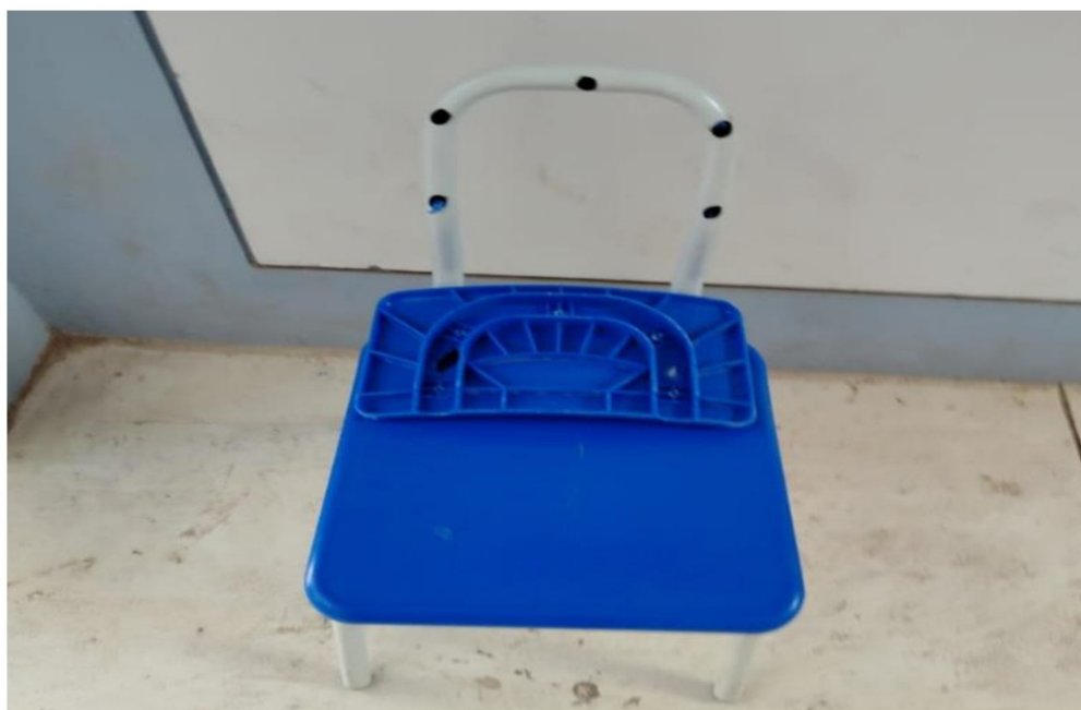
Fotografía n.° 7 Deterioro de los puntos de sujeción de los respaldos plásticos de las sillas de los niveles de inicial y primaria
