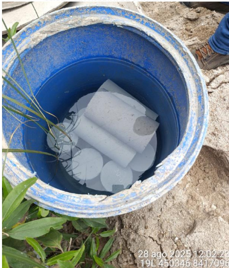
IMAGEN N° 20 CURADO DE PROBETAS DE CONCRETO
