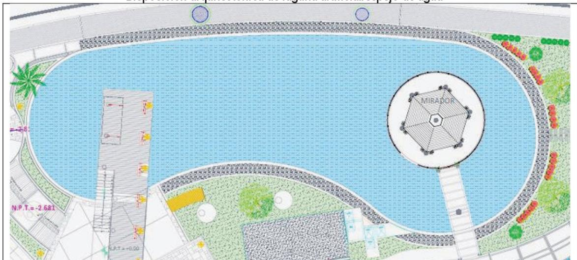
Imagen n.°4: Distribución de laguna artificial con espejo de agua de 656.53 m<sup>2</sup>.
