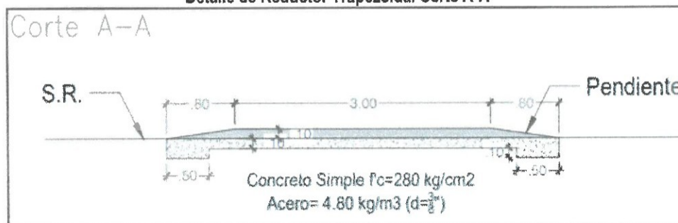
Imagen n.º 3 Detalle de Reductor Trapezoidal Corte A-A
