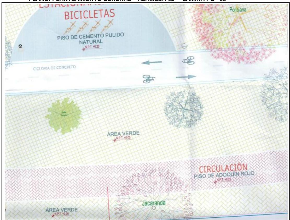
**Descripción:** Detalle del nivel de área verde, y los niveles de piso terminado de los elementos construidos siguientes: pavimento rígido, piso de concreto y piso de adoquines, y pisos de cemento.
