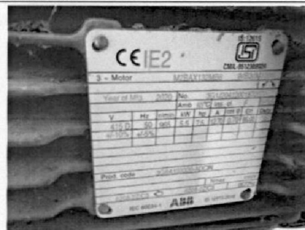
Imagen 14: Placa de datos motor eléctrico de la marca ABB de bomba de oxígeno líquido de 5.5kW de potencia y 50Hz +/- 5% de frecuencia.
