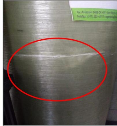
**Descripción:** Se aprecia la fisura del filtro de carbon activado
