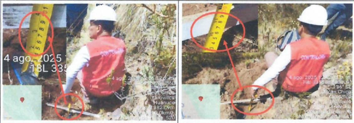
Imagen n.º 63: Vista donde se realizó la calicata n.º 1, constatándose la profundidad de entierro de la tubería de la línea de conducción de 0.075 metros = 7.50 centímetros.
