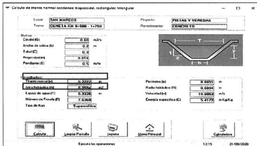
Calculo de tirante normal secciones: trapezoidal, rectangular, triangular
