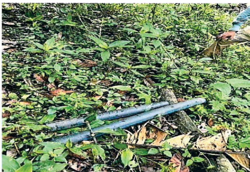
Imagen n.° 30: Se observa los restos de tubería HDPE de 2 1/2" PN10 PE100, las mismas que fallaron por la presión existente; sector: Chunatahua – Reservoirio Cayumba
