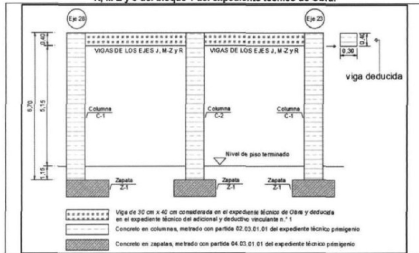
Gráfico n.° 5 Gráfico de zapatas, columnas del expediente técnico de Obra y vigas de los ejes R, M-Z y J del bloque 1 del expediente técnico de Obra.
