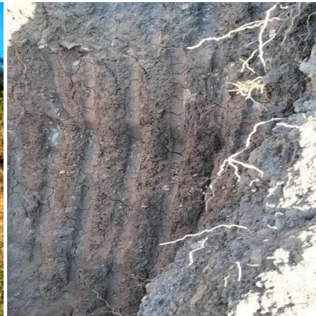
Imagen n.º 2. Material con mucha plasticidad para la conformación del relleno y afirmado de las vías.
