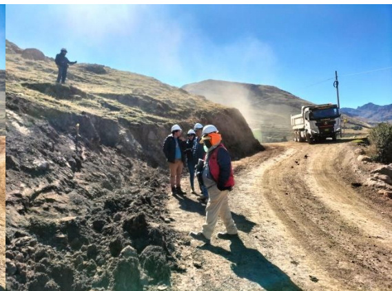
Imagen n.º 4. Cantera 4. Culluchaca, material con bolonerías y material orgánico y presenta zona de bofedales, por lo que cumpliría con la calidad de material requerida.
