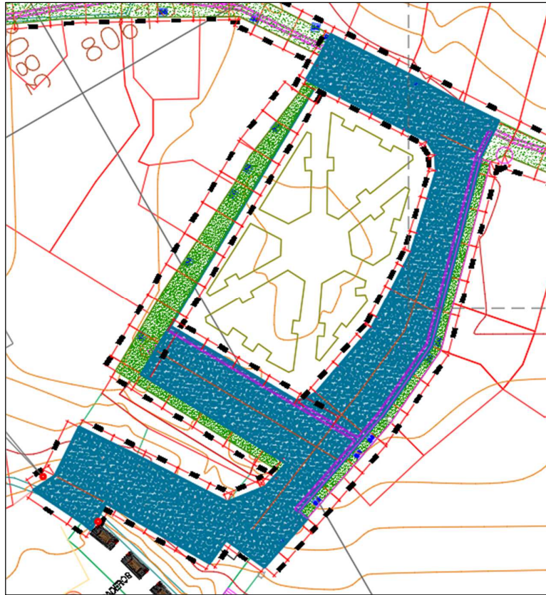
Imagen n.º 14. Pavimento rígido ejecutado al ingreso y alrededor de plaza del Centro Poblado
