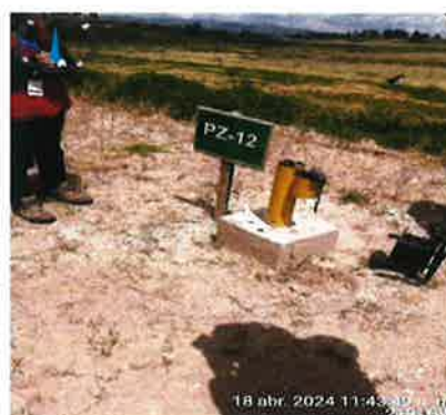
Fotografía n° 7. Se observa el Piezómetro con Código PZ-12. En este punto se realizó las mediciones de nivel freático, cuyo resultado fue en 2 metros.
