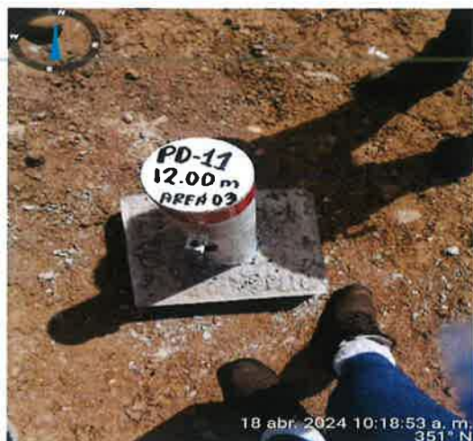
Fotografía n° 3. Se observa el Piezómetro con Código PD-11, con una profundidad de 12 metros ubicado en Área 3.
