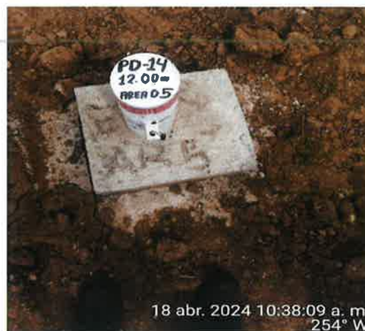
Fotografía n° 4. Se observa el Piezómetro con Código PD-14, con una profundidad de 12 metros ubicado en Área 5.
