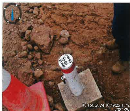
Fotografía n° 5. Se observa el Piezómetro con Código PD-15, con una profundidad de 15 metros ubicado en Área 5.
