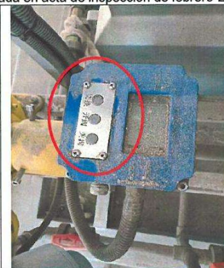
Placa de identificación de botones de operación en idioma extranjero
