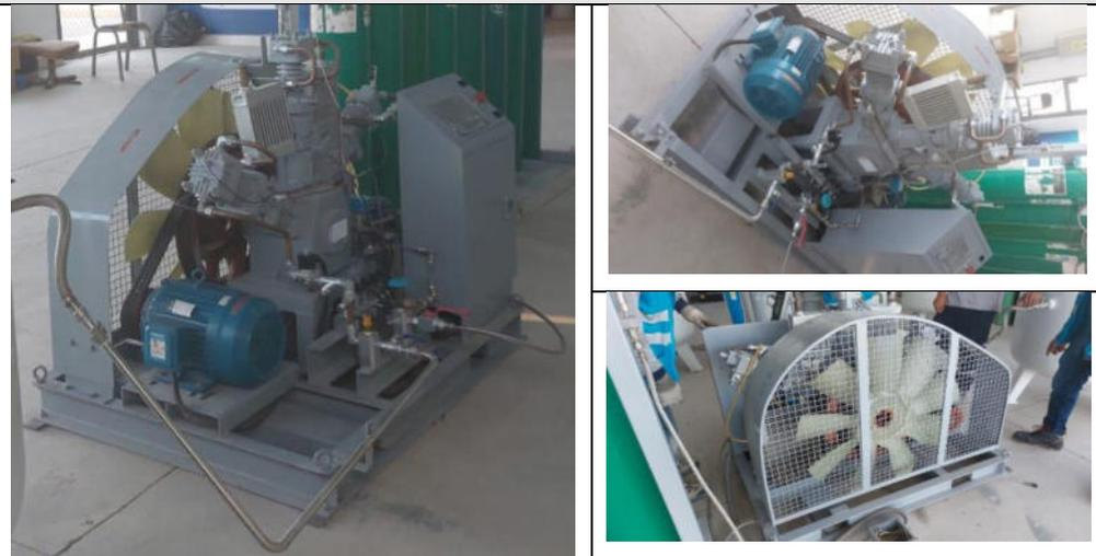
Compresora de oxígeno formada por un motor eléctrico una compresora recíprocante de 3 cilindros, gobernados por un tablero eléctrico
