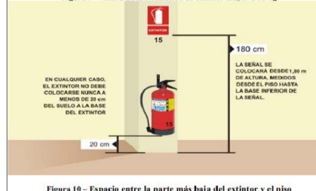
Figura 10 – Espacio entre la parte más baja del extintor y el piso
