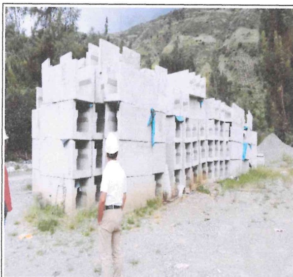
Fotografía 26: Vista de alcantarillas de concreto de sección rectangular de longitudes diferentes, pre fabricados en almacén, expuestos a la intemperie.
