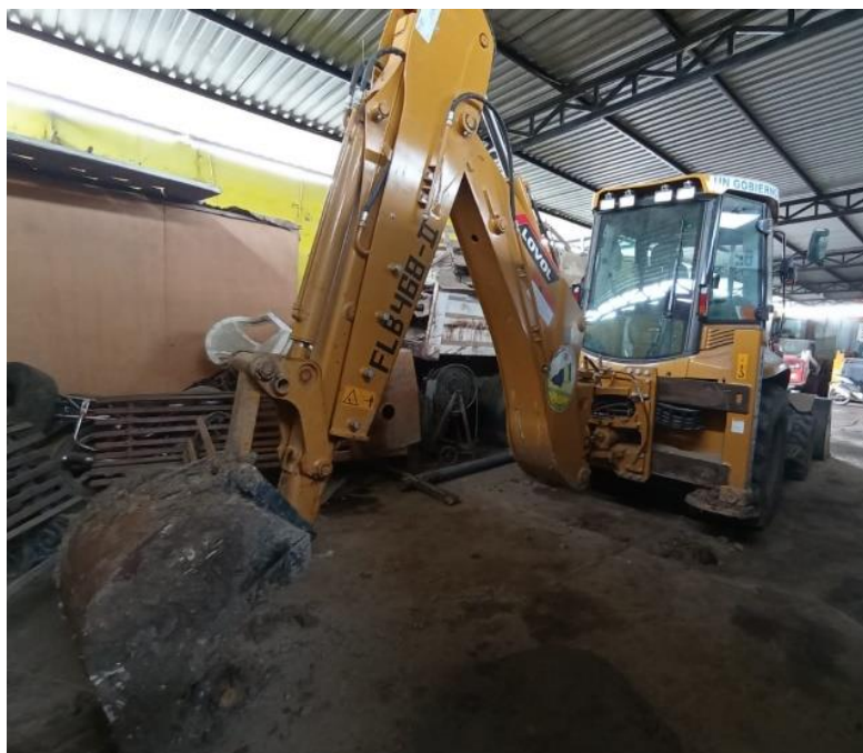
Imagen n.º 3 Brazo excavador de retroexcavadora
