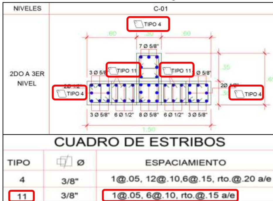
Imagen n.º 13 Distribución real de estribos en MC-1, según Plano de estructuras
