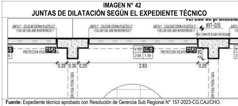
Asimismo, las especificaciones técnicas de dicha partida establecen la instalación de juntas de dilatación con espuma Plástica más jebe microporoso:
