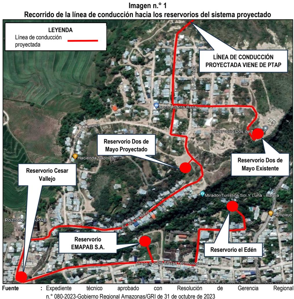
Producto de ello, el trazo de la línea de conducción del Proyecto, no mantendrá el recorrido de la línea actualmente existente, principalmente dentro de la ciudad de Bagua; lo que dará lugar a una nueva sectorización basada en el número, ubicación y capacidad de los reservorios a ser utilizados en el Proyecto.
