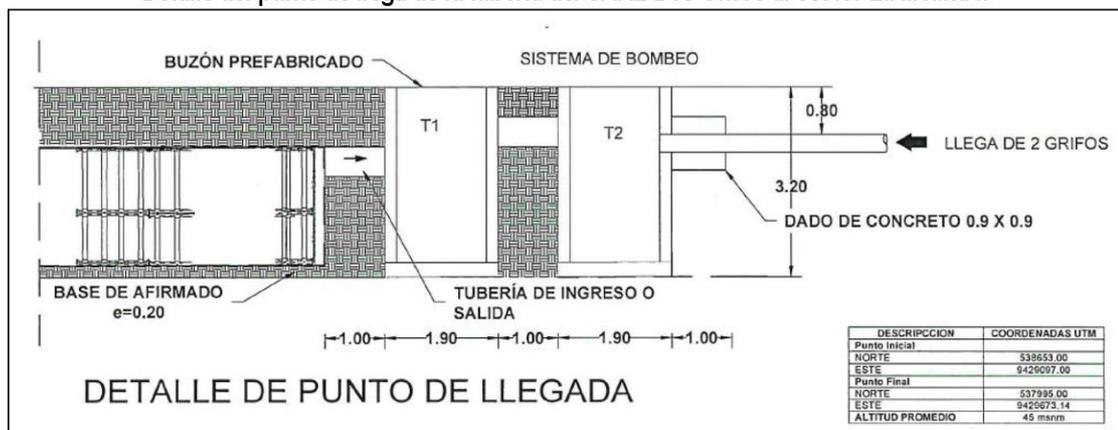
**Fuente:** Plano de corte y detalle de los Términos de Referencia del SARE Dos Grifos.
