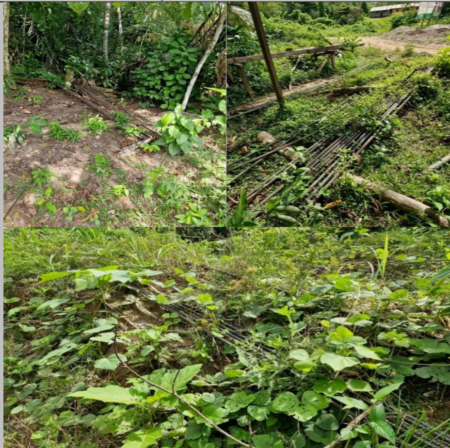
Panel fotográfico n.º7 Acero corrugado f_y=4200 kg/cm 2 situado en la maleza y tierra cerca de la zona de la inversión, se visualiza oxidación en el material
