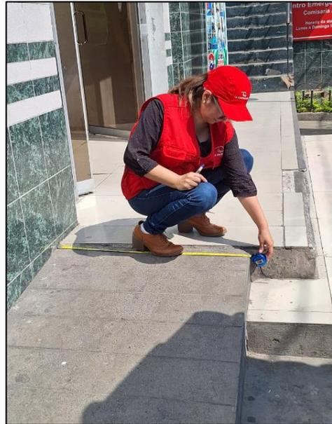
Medición del ancho de la rampa de acceso
