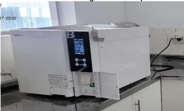
Imagen n.° 22 Esterilizador con generador de vapor
