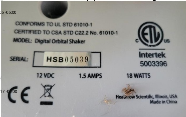
Datos técnicos del equipo “rotador serológico”
