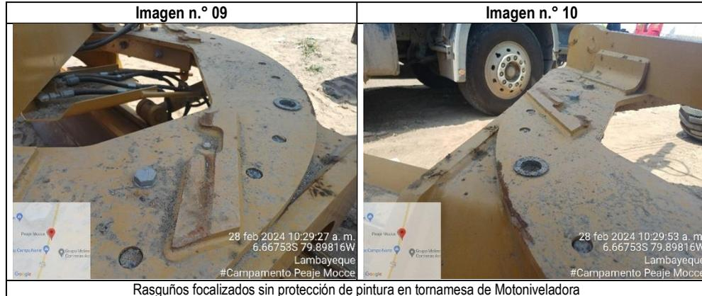
Rasguños focalizados sin protección de pintura en tornamesa de Motoniveladora
