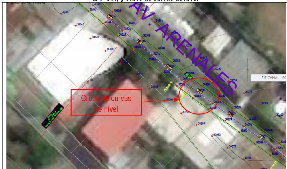
Imagen n.º06 Puntos del levantamiento topográfico ubicado en techo de viviendas desde la progresiva 0+860 al 0+810, y cruce de curvas de nivel
