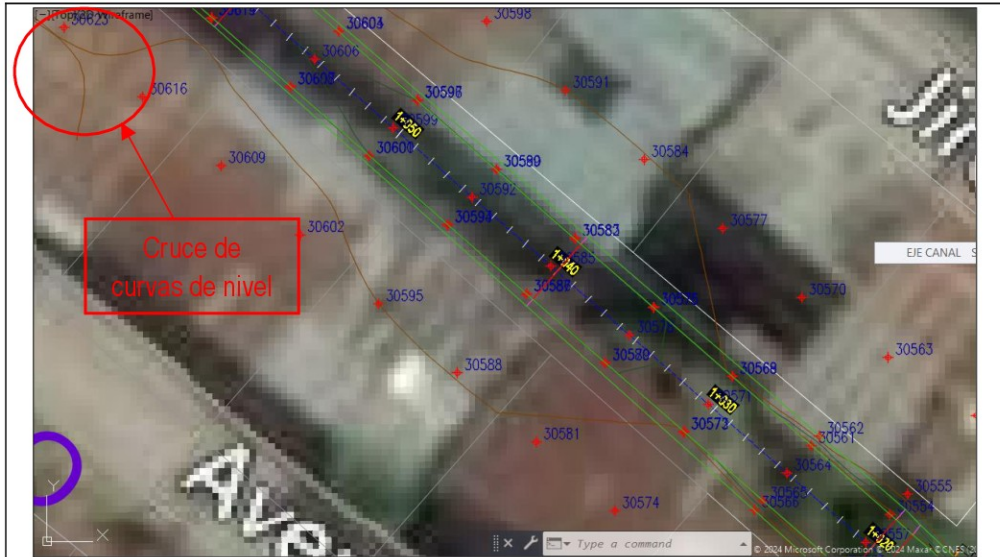
Imagen n.º4 Puntos del levantamiento topográfico ubicado en techo de viviendas desde la progresiva 1+060 al 1+020
