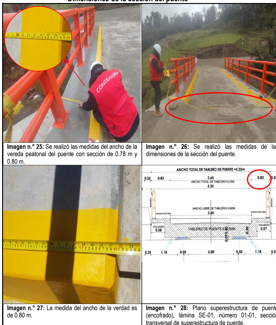
Panel de imágenes n.º 8 Dimensiones de la sección del puente
